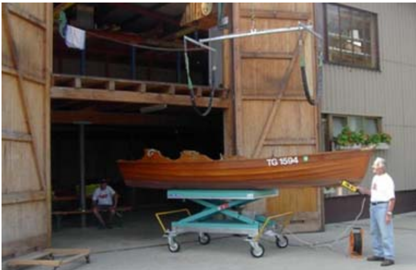
Die fahrbare Hebebühne, darüber der Aussenkran
